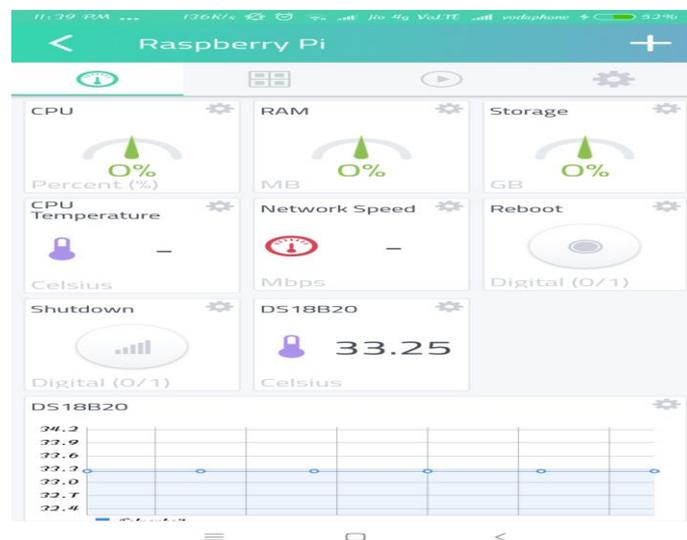
Fig-3:- Raspberry pi dashboard with DS18B20 sensor in cayenne
