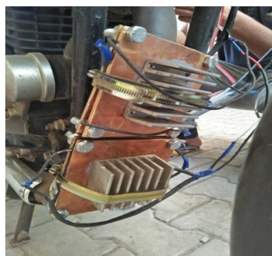
Fig. 8: Actual experimental setup of TEG assembly
