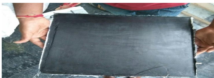
Fig: (d) Final Hybrid Composite Specimen
